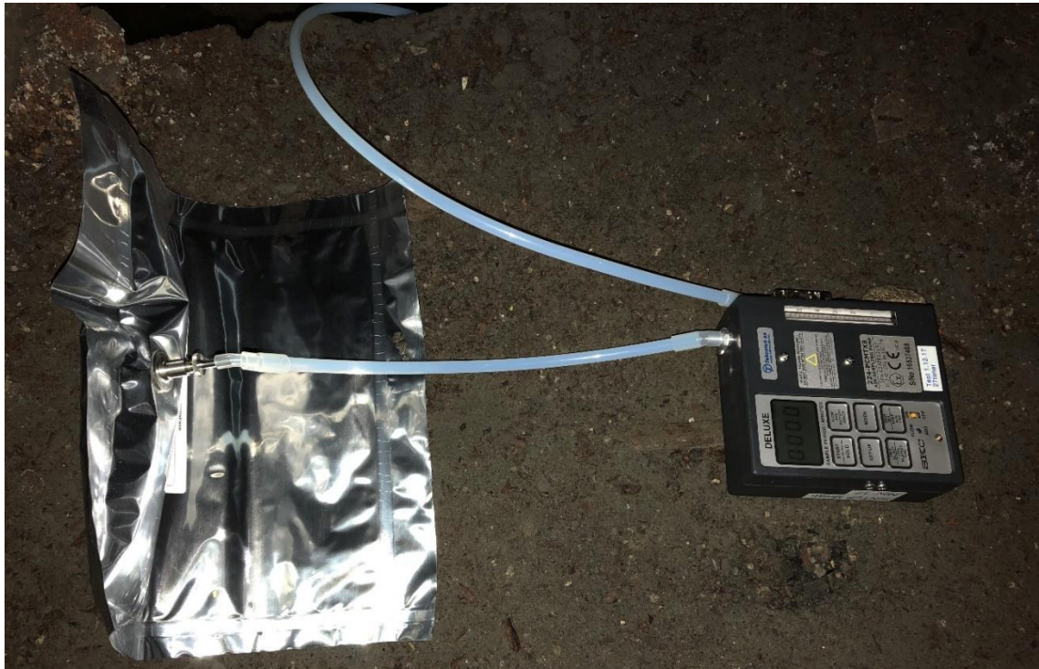
Figur 7 Gassprøvetaking fra gass nede i sjakta ved SKC gassprøvetaker.
