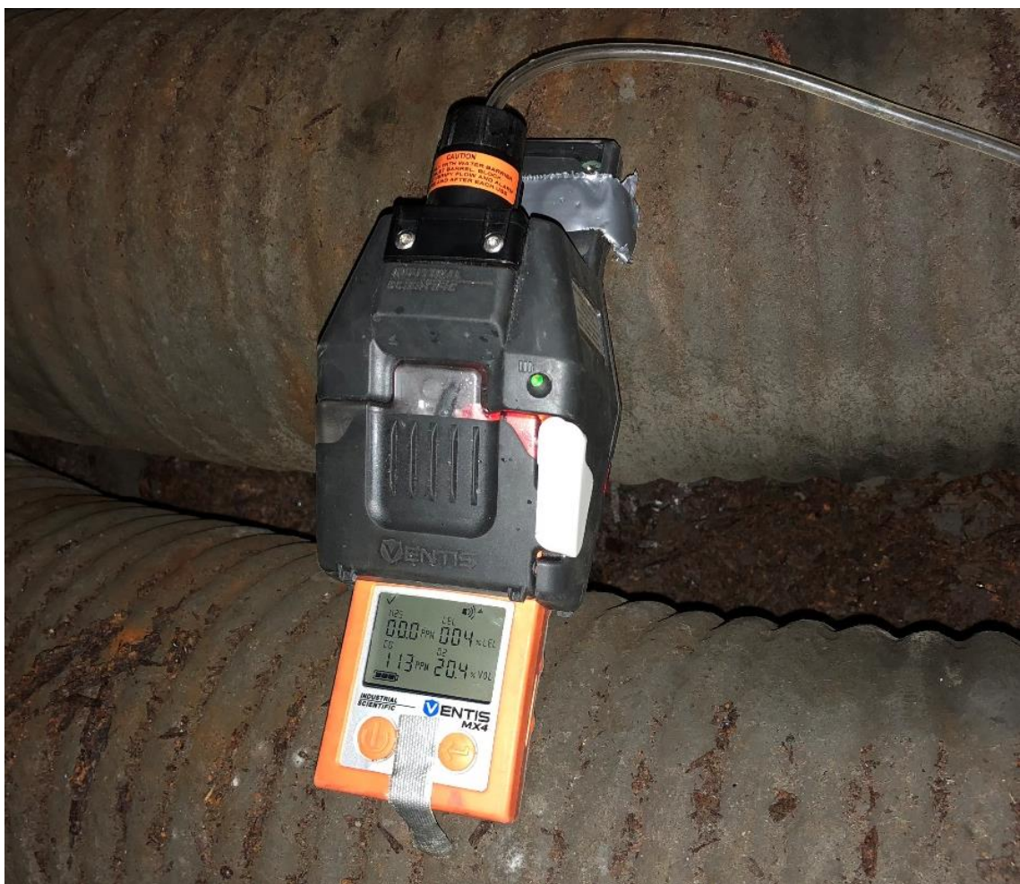
Figur 8 Ventis gassmåler med sugeslange
