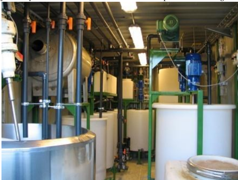
Figur 2: Et kik ind i container nr. 1. Slurry tanken ses til venstre forrest.
