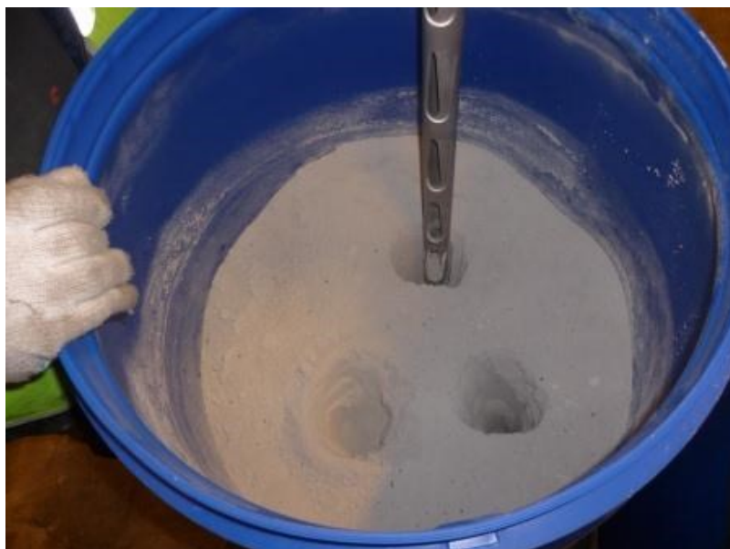
BILLEDE 12: UDTAGNING AF RÅ WET RGA (FLYVEASKE) DELPRØVER FRA VESTFORBRÆNDING
