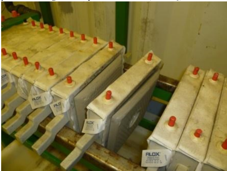
BILLEDE 15: TUNGMETALFILTERKAGER (TMP) TIL SAMLEPRØVER FRA VESTFORBRÆNDING
