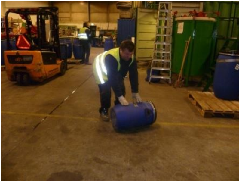
BILLEDE 13: BLANDING AF RÅ WET RGA (FLYVEASKE) SAMLEPRØVER FRA VESTFORBRÆNDING
