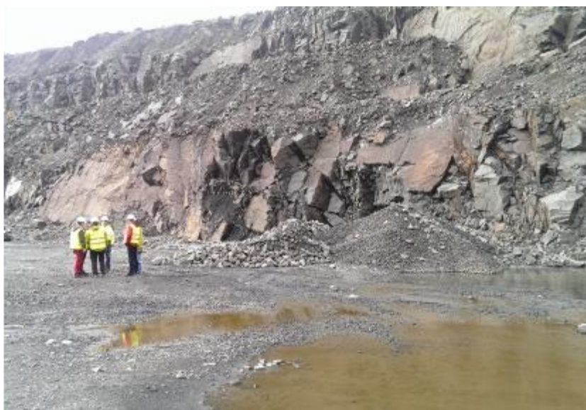
Figur 27. Venstre: Jern- og manganutfellinger i sprekkesoner i dagbruddet. Høyre: Merk jernutfellinger på gamle sprekkeflater, ved personene i forgrunnen (foto: K.J.Tuttle).
