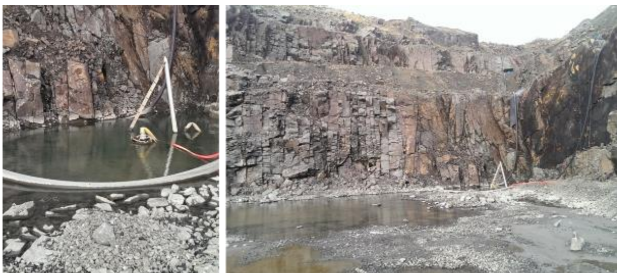
Figur 30. Nordveggen av dagbruddet på Vallnes. Vannpumpe til lensing av vann fra bruddet (foto: K.J. Tuttle).
